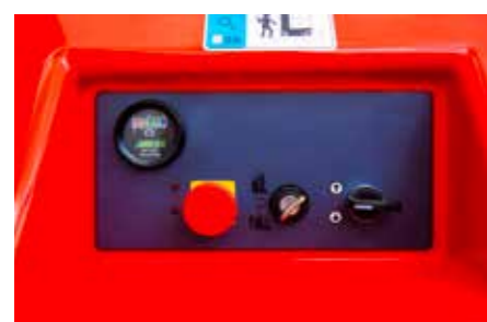
Кнопка аварийной остановки
