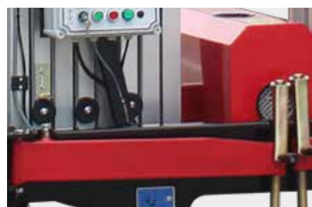
Блокиратор выносных опор
