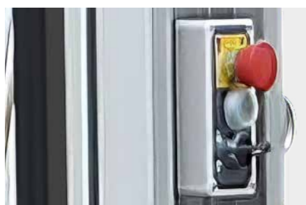
Кнопка аварийной остановки
